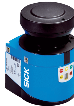
Sick LMS 100 Winkelauflösung: 0.25^\circ / 0.5^\circ Scanbereich: 270^\circ Scanfrequenz 25/50 Hz Reichweite: 18 m
