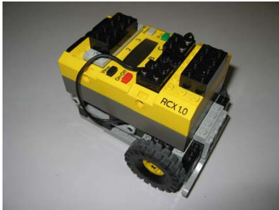
Abbildung 1: Lego Mindstorms Roboter. Der RCX enthält einen Mikrocontroller, mit dem die beiden Antriebsmotoren angesteuert werden.
