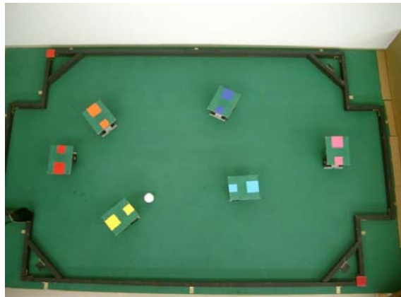
Abbildung 2: Spielfeld mit 6 Lego-Mindstorms-Robotern. Das Spielfeld, das mit einer Bande versehen ist, misst die Größe 170 cm auf 110 cm. Gespielt wird mit einem Golfball.
